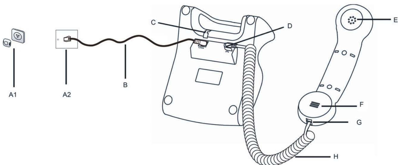
1. Inserire l'estremità mini jack del cavo di collegamento della cornetta telefonica (H) nella presa
