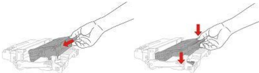
6. Prendere componente tamburo nella cartuccia installata, installare componenti tamburo con la cartuccia installata lungo il cursore stampante per completare l'installazione.
