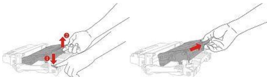
4. Aprire la nuova confezione del componente tamburo, rimuovere il componente tamburo del dispositivo di protezione, e mettere il componente di tamburo su una superficie livellata.
