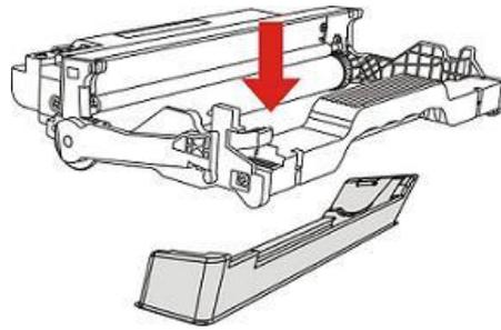
5. Inserire la cartuccia nel componente tamburo lungo il binario, per completare l'installazione della cartuccia.
