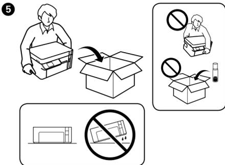
Halten Sie die Tintenflasche beim Anziehen der Kappe aufrecht. Platzieren Sie den Drucker und die Flasche in getrennten Plastikbeuteln und halten Sie den Drucker beim Lagern und Transport horizontal. Andernfalls könnte Tinte austreten.
